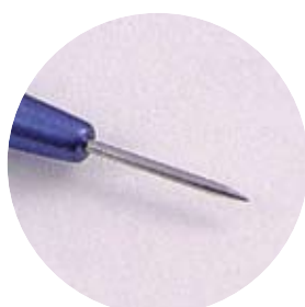
Пика-проводник, рабочая часть длиной 8 мм, диаметр 0,67 мм, титановая ручка диаметром 5 мм, общая длина 58 мм
